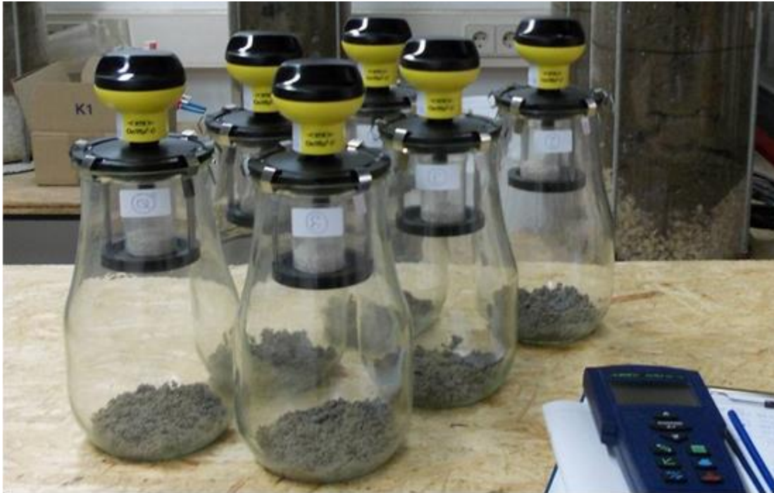
Abb. 5: Darstellung des prinzipiellen Aufbaus der AT4-Versuchsreaktoren
